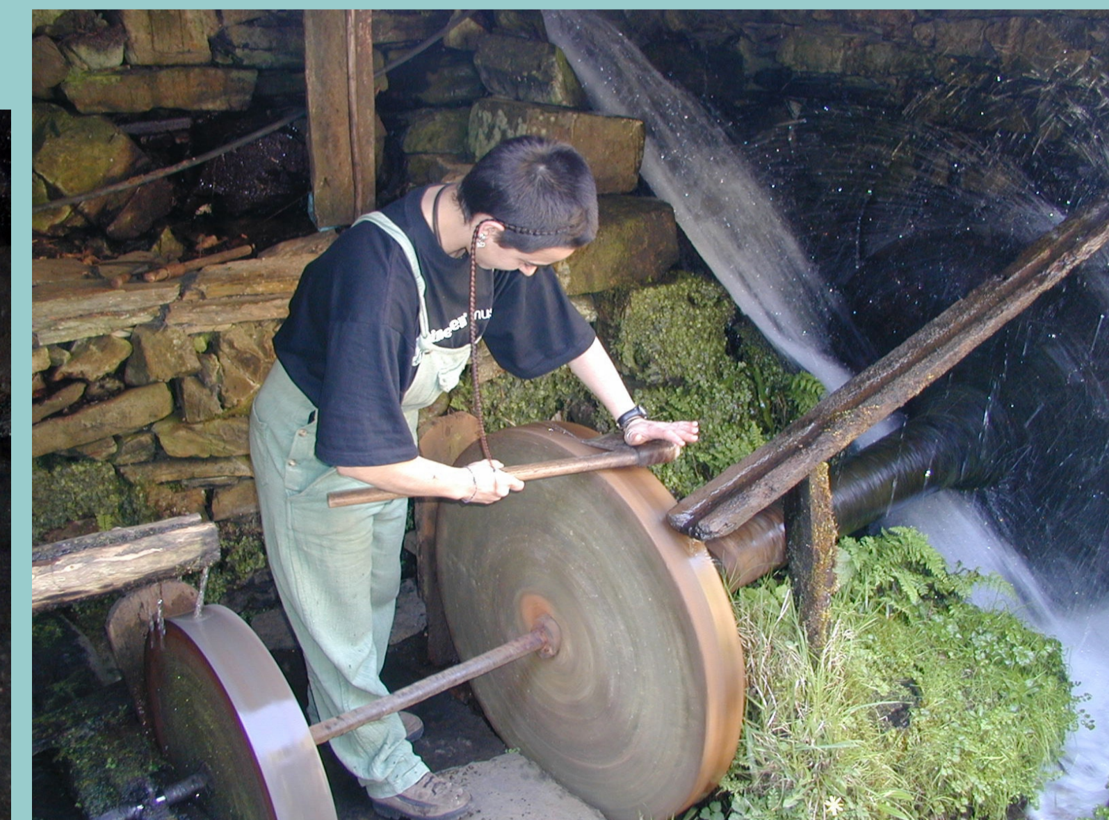
Rodas de afiar: mecanismos para afiar as ferramentas movidos por unha roda hidráulica.
